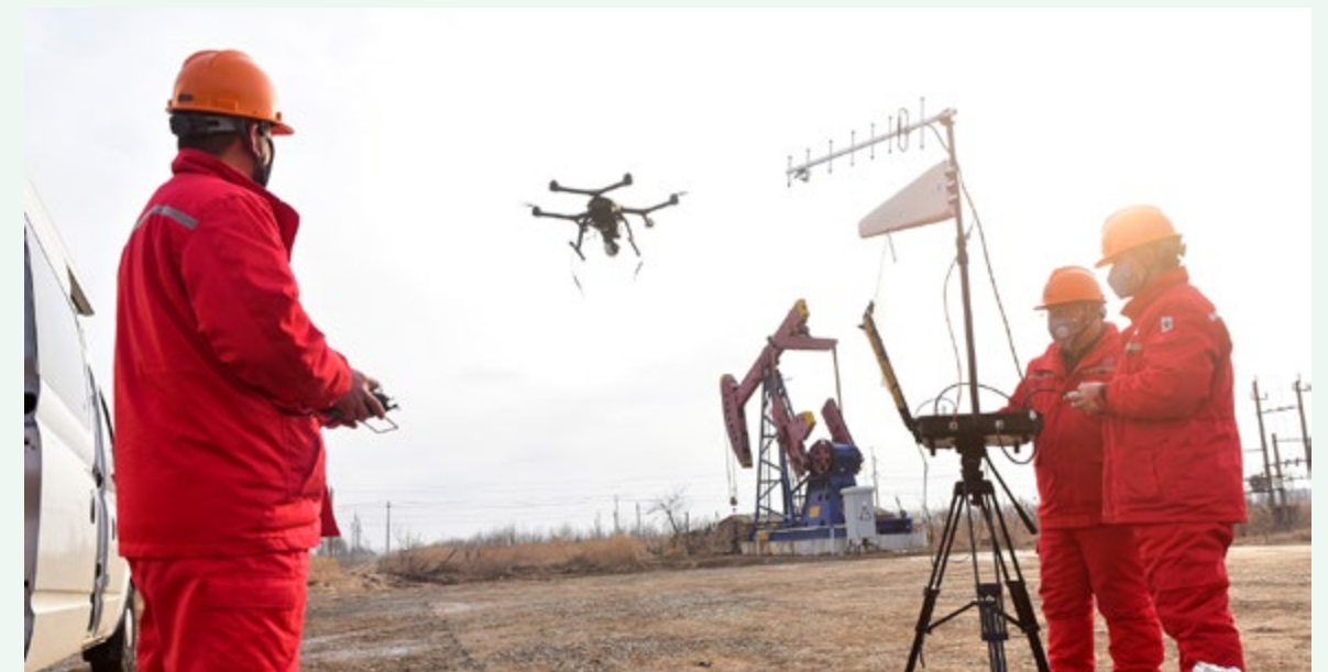
胜利油田采用无人机对重点油区、油井、输油干线进行巡检
